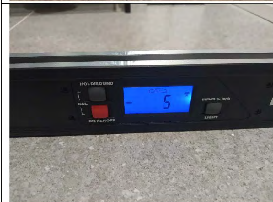
Фото №17. Измерение уровня напольного покрытия в ванной комнате (керамическая плитка).
