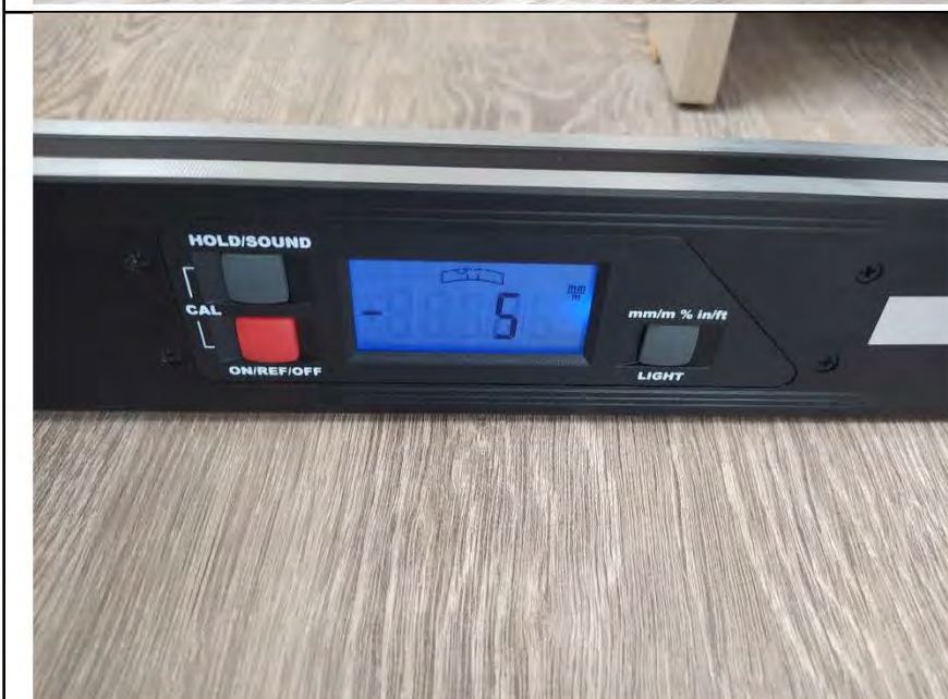
Фото №14. Измерение уровня напольного покрытия в гостиной
