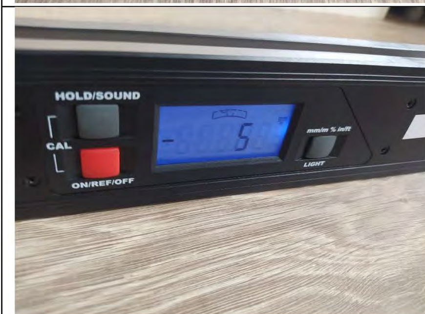
Фото №15. Измерение уровня напольного покрытия в кухне.
