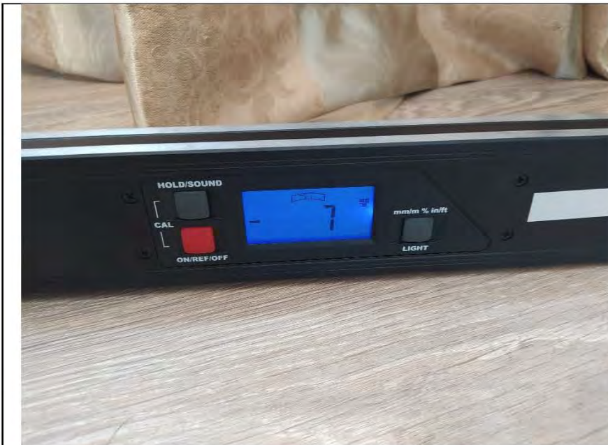
Фото №13. Измерение уровня напольного покрытия в спальне.
