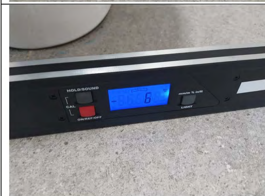
Фото №18. Измерение уровня напольного покрытия в санузле (керамическая плитка).
